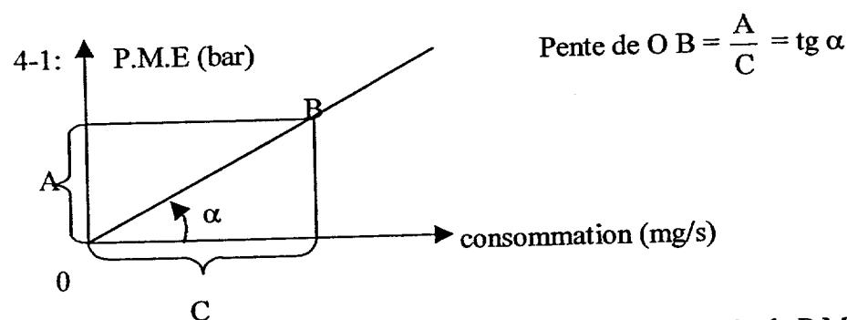
On montre que à régime constant, et pour une cylindrée donnée, la P.M.E est proportionnelle à la puissance effective, et le débit de carburant est l'image de la puissance introduite.
