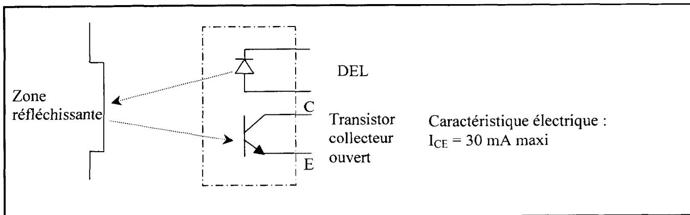
La diode électro-luminescente (DEL) est alimentée en permanence.
