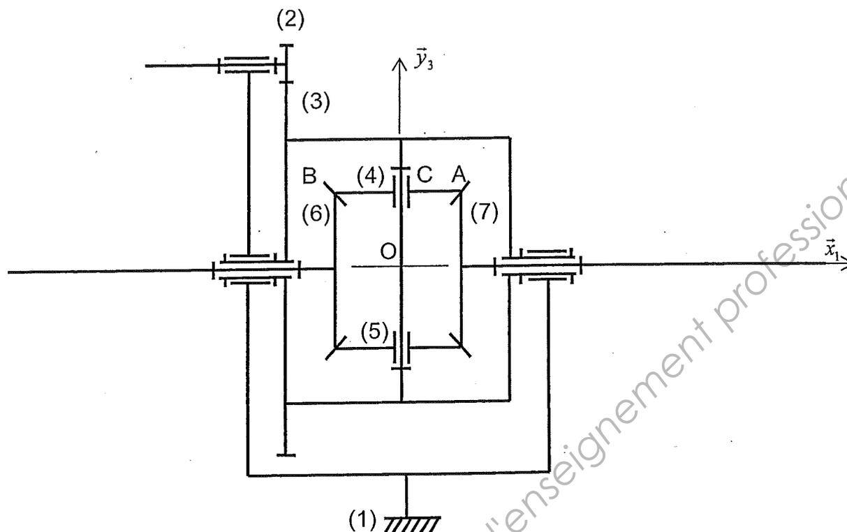
Le pignon 2 de sortie de boîte de vitesses engrène avec la couronne liée au boîtier de différentiel 3.
