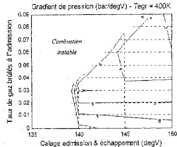
*Evolution de la température des gaz brûlés et du gradient de pression pour différents taux de gaz brûlés à l'admission à 1500 tr/min*
