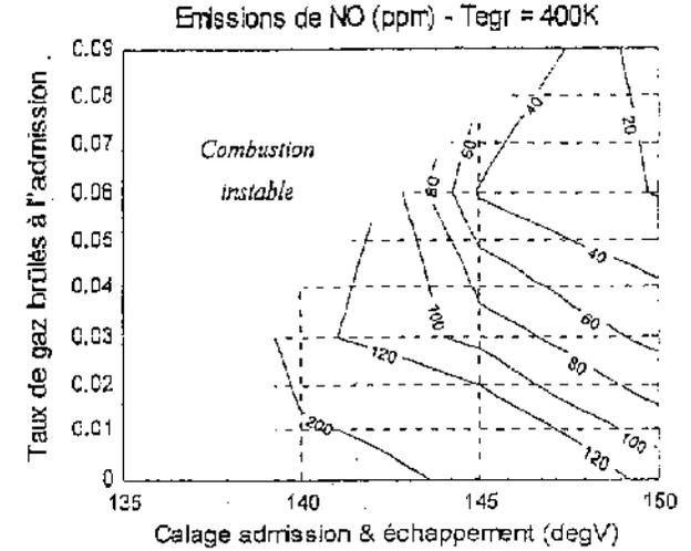
*Evolution de la température cylindre maximale et des émissions de NO pour différents taux de gaz brûlés à 1500 tr/min*
