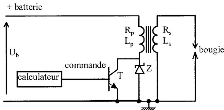
Sur le circuit magnétique de la bobine sont placés l'enroulement primaire de résistance  $R_p$  et d'inductance  $L_p$  ainsi que l'enroulement secondaire de résistance  $R_s$  et d'inductance  $L_s$ .
